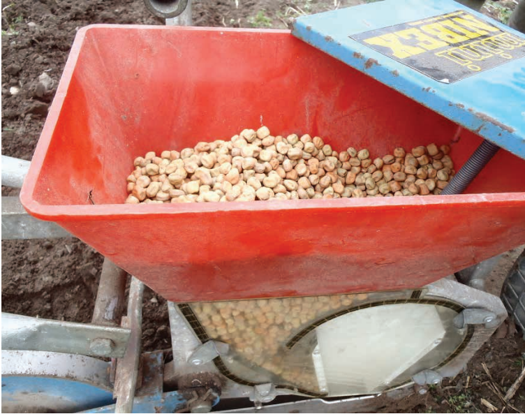
Enkornssåmaskinen, der sør for den korrekte mængde ærter.
